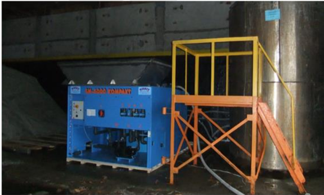
Automatizuota druskos tirpinimo ir sandėliavimo įranga
