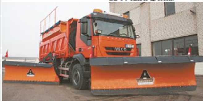
Šoninis sniego valytuvas montuojamas dešinėje automobilio pusėje kartu su priekiniu valytuvu, nuvalantis sniegą iki 6 metrų pločio.
